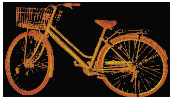
計測例：5m離れて計測。自転車の各スポークまで高密度で表現されている。
