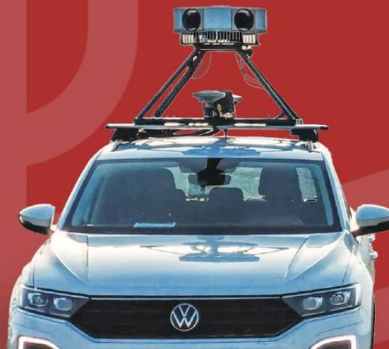
Mosaic Viking はクラス最高の 360° モバイルマッピングカメラです。3D モデリング、デジタルツインの作成、また AR プラットフォームの構築に使用されています。極めて大きな空間を最も過酷な状況下でも極細部までとらえるために、従来製品とは別にゼロから設計・製造されています。グローバルシャッターを採用し、高画像モバイルマッピングの分野では唯一のオールインワン 360° カメラシステムです。全方位カメラ（6台）により画像データを取得し、マッピング、3D モデリング、VFX、デジタルツイン、写真測量、道路維持管理などのインフラ維持に使用されています。SfM ソフトウェアで高解像度の画像から 3D モデルを構築できます。
